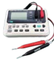
バッテリーの内部抵抗を 測定し、劣化状態を診断
